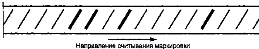
Рисунок 2 — Пример прокатной маркировки предприятия-изготовителя под номером 14
